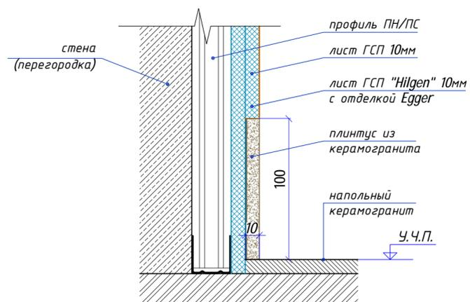
Устройство скрытого плинтуса из керамогранита в местах монтажа декоративных облицовок стен с креплением к базовой стене.
