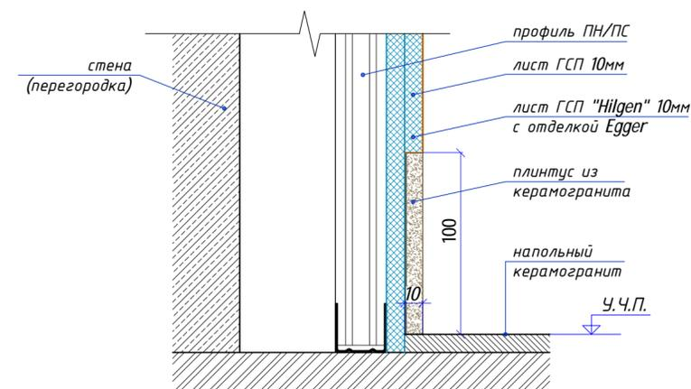
Устройство скрытого плинтуса из керамогранита в местах монтажа декоративных облицовок стен на основе от базовой стены.
